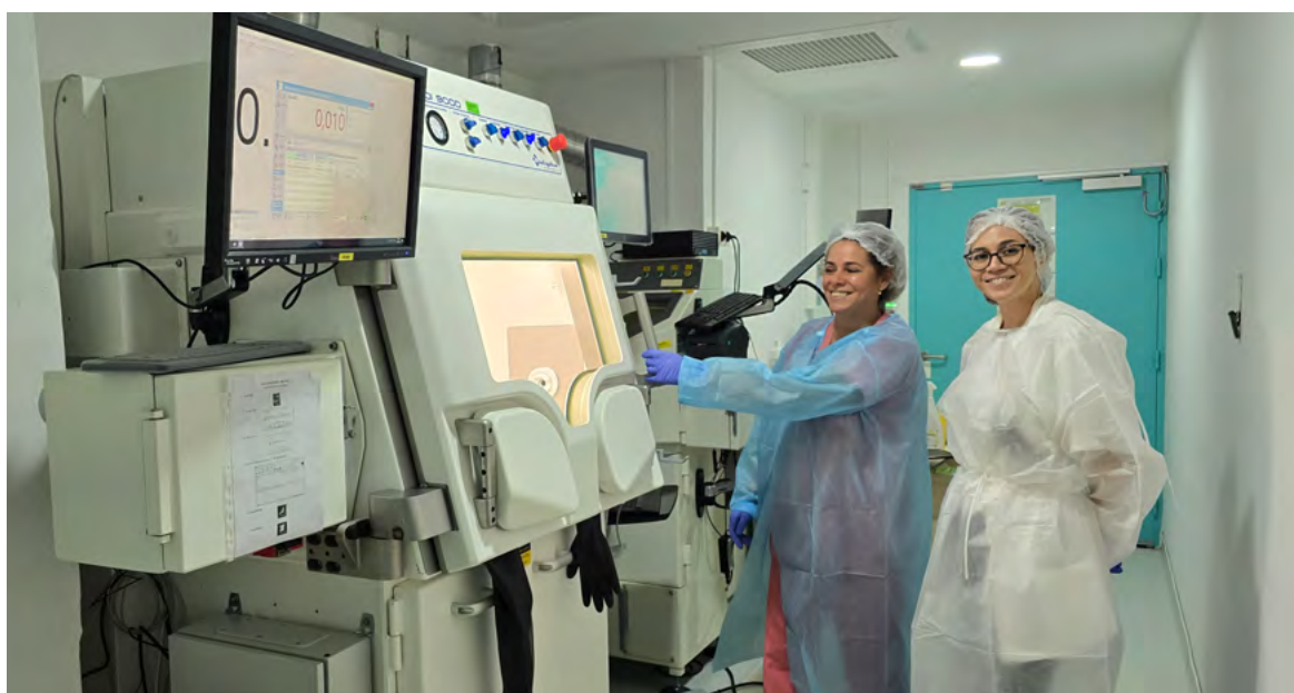
Figure 48: Hotte blindée dédiée à la synthèse du 68 Ga-PSMA11, un émetteur de positons utilisé en imagerie TEP pour le suivi des récurrences de cancer de la prostate / Shielded fume hood dedicated to the synthesis of 68 Ga-PSMA11, a positron-emitting radiotracer used in PET imaging for monitoring prostate cancer recurrence (© P. Dupire)
